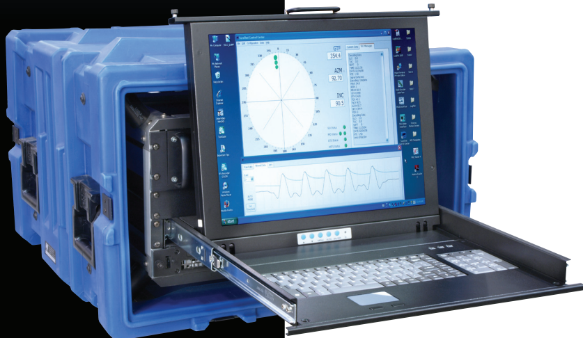
“抗振型” SureShot集成了服务器与显示终端
